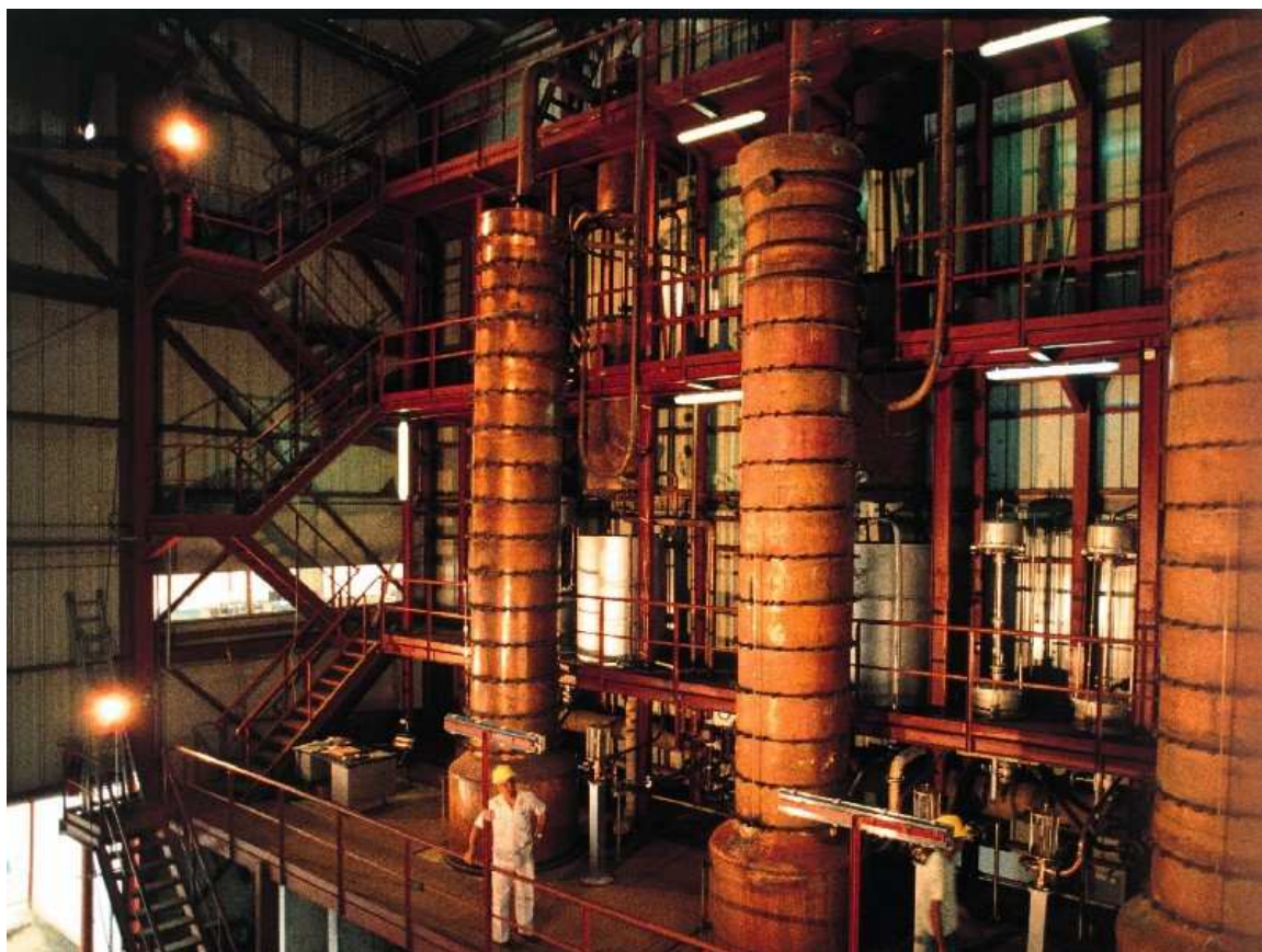
Figura 5-1: Dos de las cuatro columnas de destilación para la obtención de “ron agrícola AOC ” de la destilería La Mauny, Rivière Pilote, Martinica FWI (foto cortesía La Mauny).
